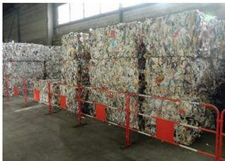
Les produits finaux comme les bouteilles en plastiques sont compressés en cubes dignes d'œuvres d'art contemporain. Ces matériaux bruts seront transformés en fibres de rembourrage, emballage, tuyaux ou pièces d'industrie automobile. Sur l'ensemble du SITREVA, le syndicat arrive à valoriser 91% des déchets.
